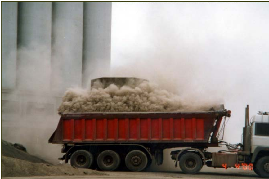
2 dispersione di polveri nel caricamento di clinker su camion
