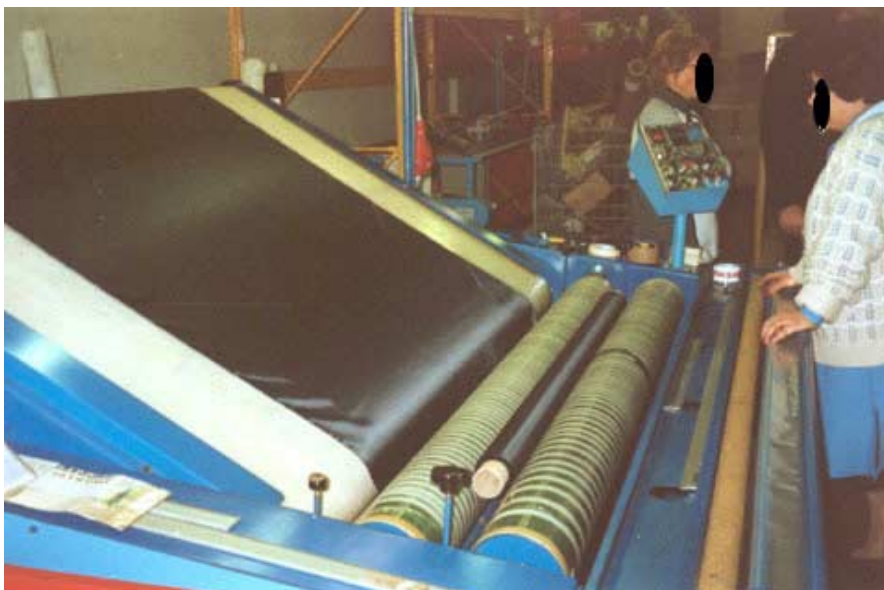
Fig. n. 1: macchina specchio per controllo tessuto dotata di rulli avvolgipezza con protezioni rimosse.
