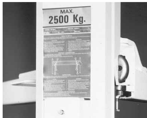
Figura 1: la portata deve essere indicata chiaramente.
