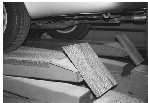
Figura 4: dispositivo di arresto con attivazione automatica ad ogni movimento verso l'alto del sollevatore.
