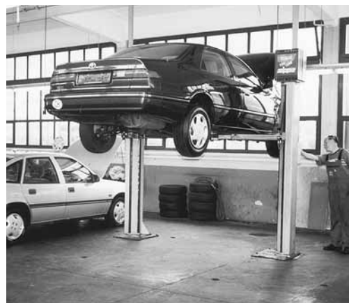
Figura 2: in questa zona l'operatore ha una perfetta visibilità e non esiste alcun pericolo di schiacciamento.
