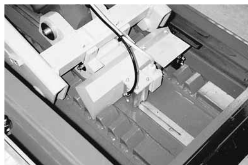
Figura 3: nottolino contro la discesa accidentale.
