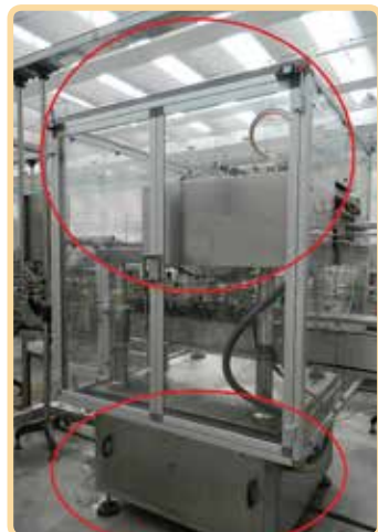
Pendagliatrice – ripari fissi e ripari mobili con interblocco
