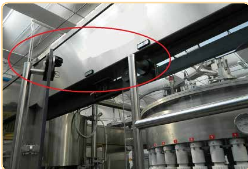
Riempitrice – Riparo mobile con interblocco; lo spessore del pannello è tale da consentire la riduzione del rumore
