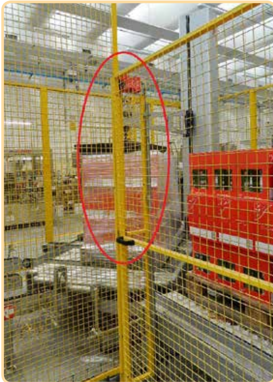
Pallettizzatore – riparo mobile con interblocco
