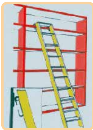
Figura 2: Dispositivi di trattenuta/antiscivolo all'estremità superiori.
