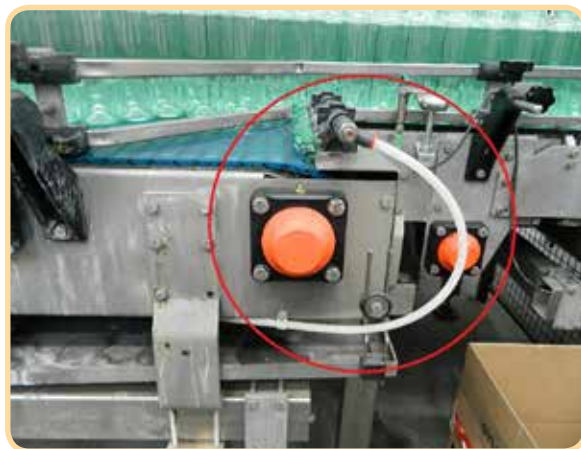
Nastro trasportatore – protezione degli organi in movimento
