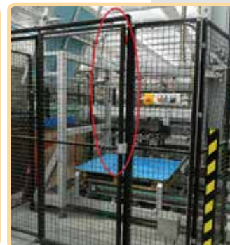
Depallettizzatore riparo mobile con interblocco
