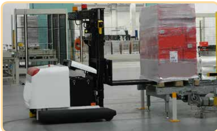
Pallettizzatore – scarico del pallet completo
