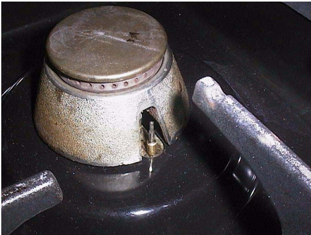
Elemento della termovalvola presente su ciascun fuoco che in caso di spegnimento della fiamma interrompe il flusso di gas.
