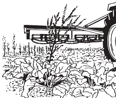
Fig. 3 - Irroratrice agente per contatto o "a umettazione".
