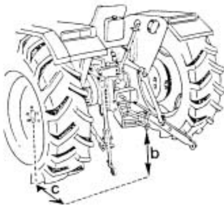
Fig. 9 - Altezza e sbalzo della barra di traino.
