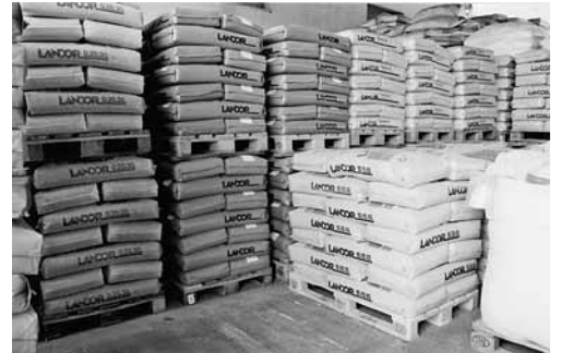
Figura 6: deposito di sacchi su palette di legno. Per non pregiudicare la qualità del prodotto, l'altezza della catasta deve limitarsi a due palette.
