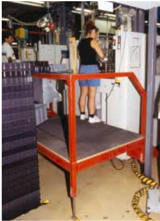
Figura 2: le pedane regolabili in altezza migliorano l'ergonomia e incrementano la produttività del 10%.
