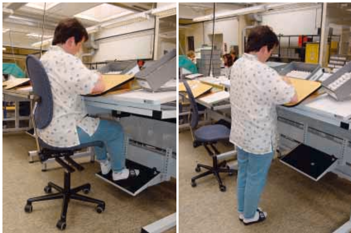
Figure 10 e 11: in questo reparto dove si montano pezzi di precisione la postazione di lavoro deve essere concepita in modo tale da permettere alternativamente la posizione seduta e in piedi.
