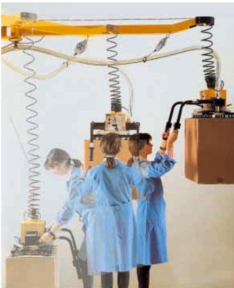
Figura 22: l'impiego di un «balancer» facilita la movimentazione dei carichi senza un grande impegno muscolare.
