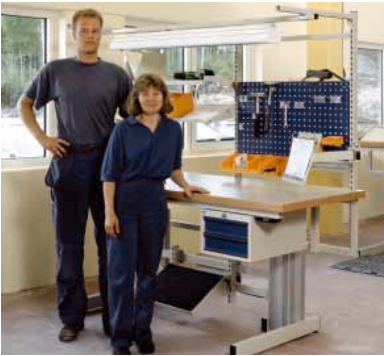
Figura 13: persone di corporatura diversa necessitano di posti di lavoro adattati alle loro caratteristiche fisiche e con elementi regolabili.
