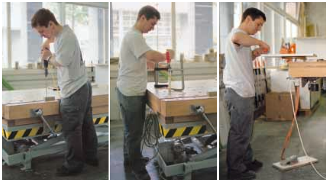
Figure 14, 15 e 16: a seconda della mansione è possibile regolare in altezza la superficie di lavoro del banco da falegname.
