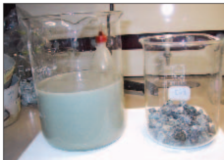
Foto 57/58 – Lavaggio frazione grossolana
