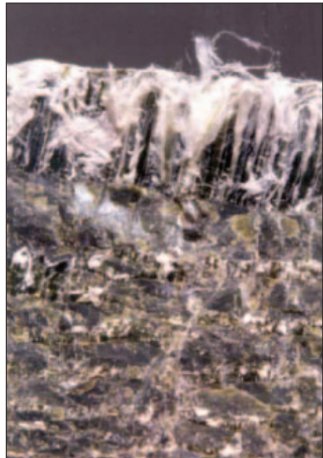
Foto 20 – Particolare di fibre di crisotilo in serpentino
