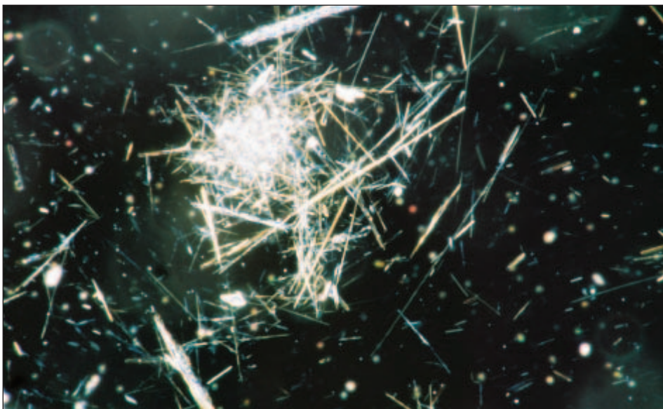
Foto 51 – Fibre di tremolite - MOLP: 1,580
